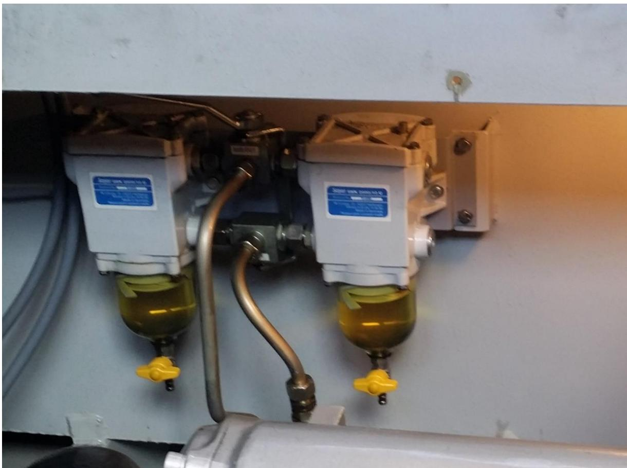
Hier eine Doppelfilteranlage vom Typ SEPAR mit Schauglas und der Möglichkeit Wasser und Schutz abzulassen. Zum Wechseln der Filter entfernt man die 4 Schrauben und nimmt den Deckel ab. Bei Doppelfilteranlagen kann man während der Fahrt einen Filter warten. Dies ist für einen Binnenfahrer jedoch nicht von grosser Bedeutung. Der wird auf den sauberen Filter umschalten und dann irgendwo anlegen und weitersehen.
